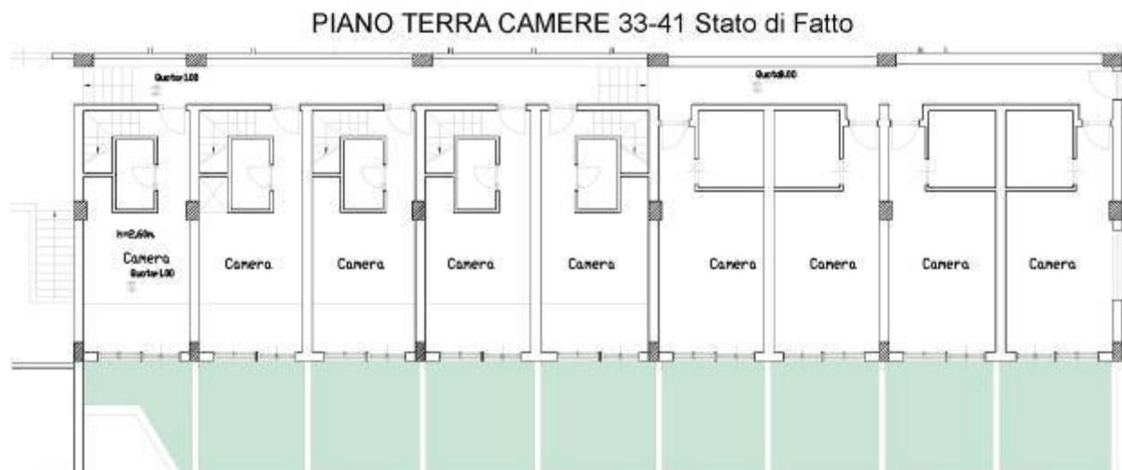
L'abuso riscontrato è sanabile, a seguito del pagamento di una sanzione pecuniaria, ai sensi dell'art. 37 del D.P.R. 380/2001, in quanto **trattasi di aumento di superficie non residenziale** individuata dai terrazzini di pertinenza di ogni camera, ed il cui **volume sottostante è assimilabile ad un volume tecnico non comportante aumento di volumetria.**
