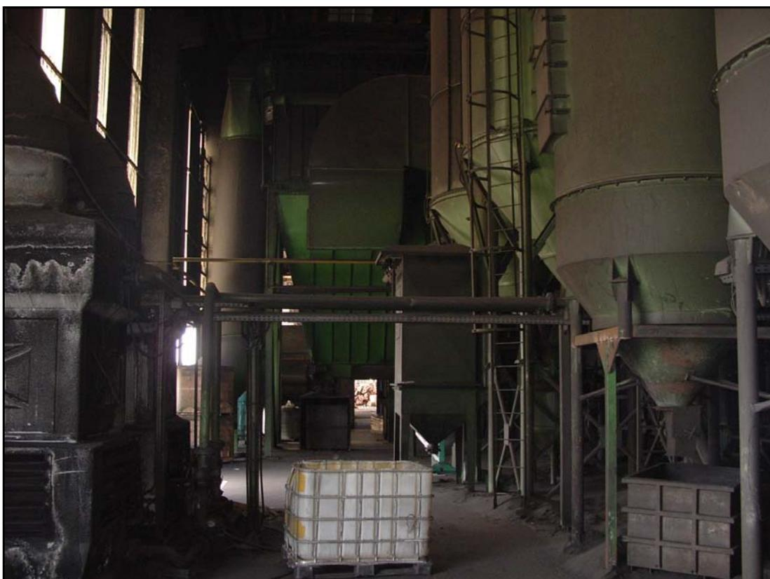
**FOTO N° 29: Torre di Rigenerazione e Silos recupero terre da 115 mc (Impianto Distaffatori)**
