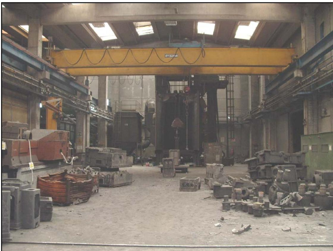
**FOTO N° 36: Reparto Shaveria-Spedizioni-Sabbiatrici o Granigliatrici- In fondo Sabbiatrice Marca OMSG modello CAPRI 25/40/H116 matr. 9636 Anno Costruzione 1995 e gru a ponte bitrave sigla 4661 portata 25 T**
