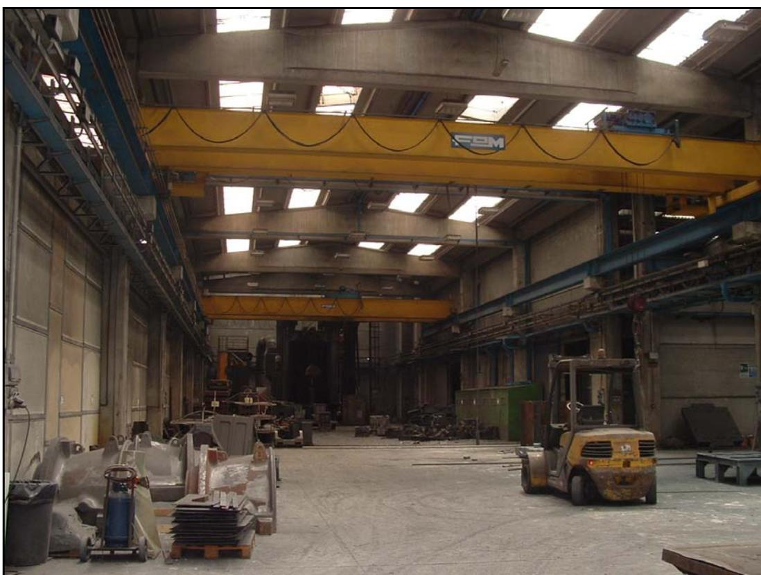
**FOTO N° 37: Visione allargata foto 36 –Sabbiatrice Capri e seconda gru a ponte bitrave sigla 4660 portata 10 T**
