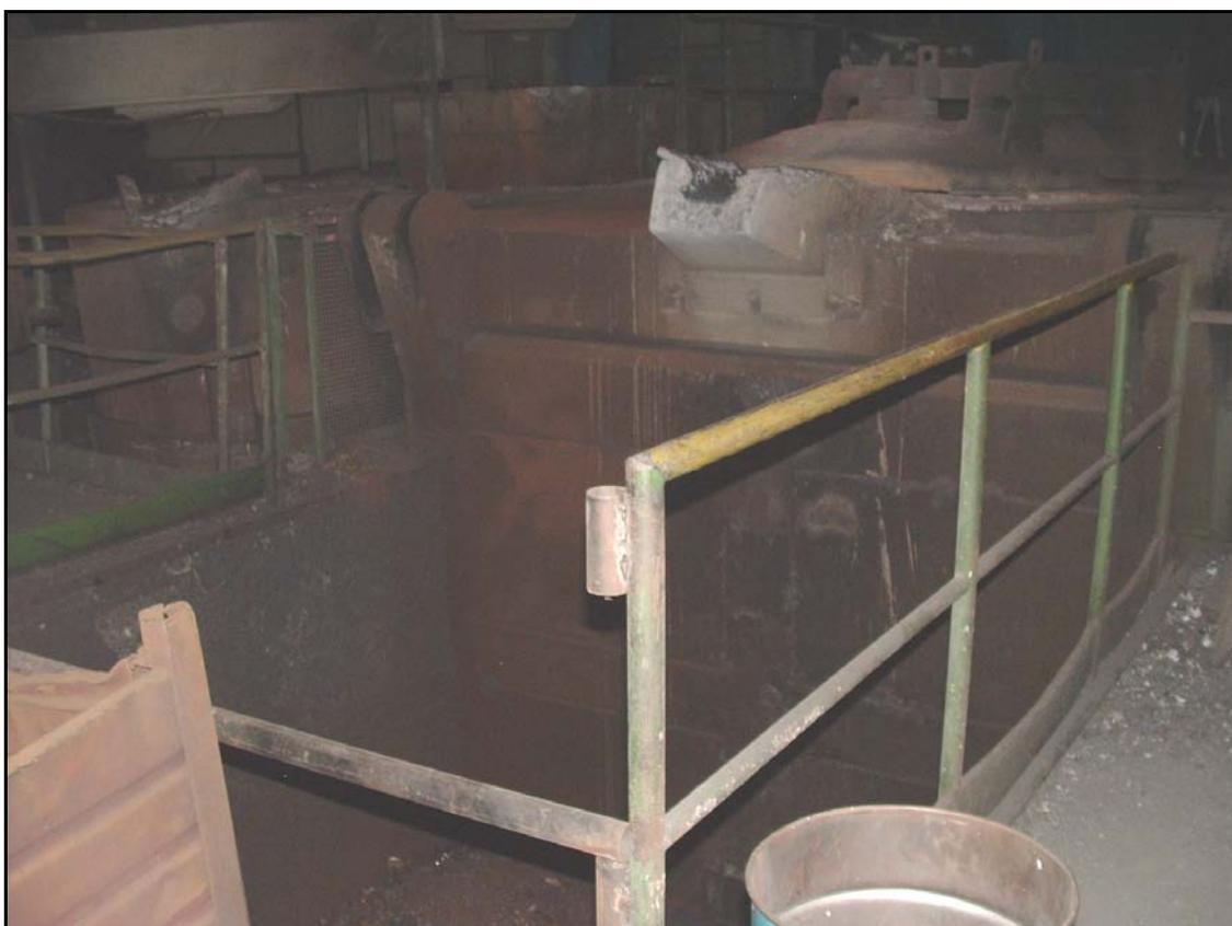
**FOTO N° 59: Forno Elettrico da 15 Tonnellate Modello CPC/500 Anno 1995**
