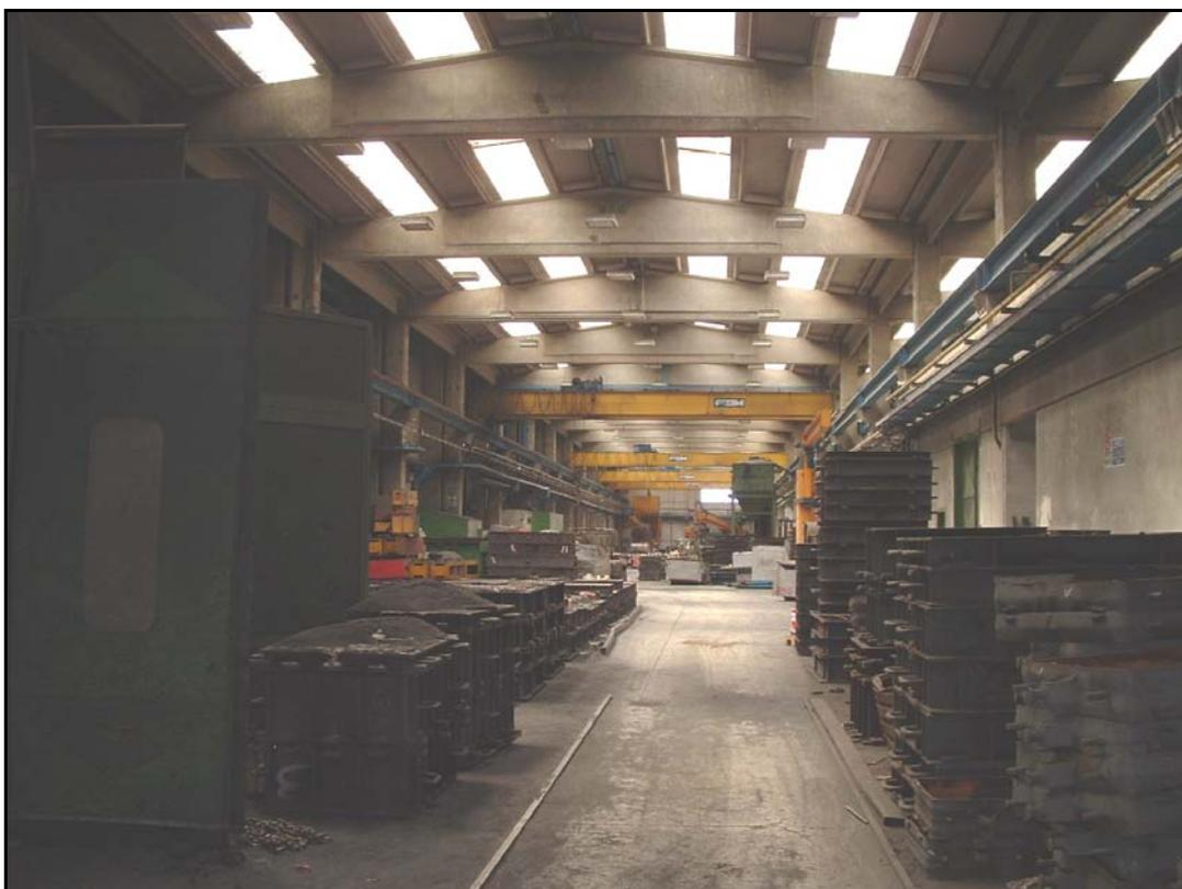
**FOTO N° 39: Campata B Capannone –Distaffatore Piccolo produttur IMF e n° 3 gru a ponte bitrave sigla NF 4655 DA 10 T, sigla NF 4653 DA 10 T, NF 4654 DA 10 T In questo reparto vi sono un mescolatore fisso ed un mescolatore su binario in fondo.**
