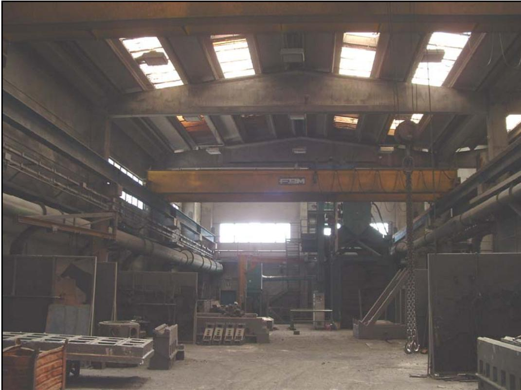
**FOTO N° 34: Reparto Sbaeria-Spedizione-Sabbiatrici o Granigliatrici- In fondo Sabbiatrice OMSG modello TBLAST 2020/16 WR STRW C matr. 11060 Anno Costruzione 2007 e gru a ponte bitrave sigla NF4717 da 25 T e n° 2 gru a bandiera sigla 756/05 da 1 T e sigla 0035 da 2 T**
