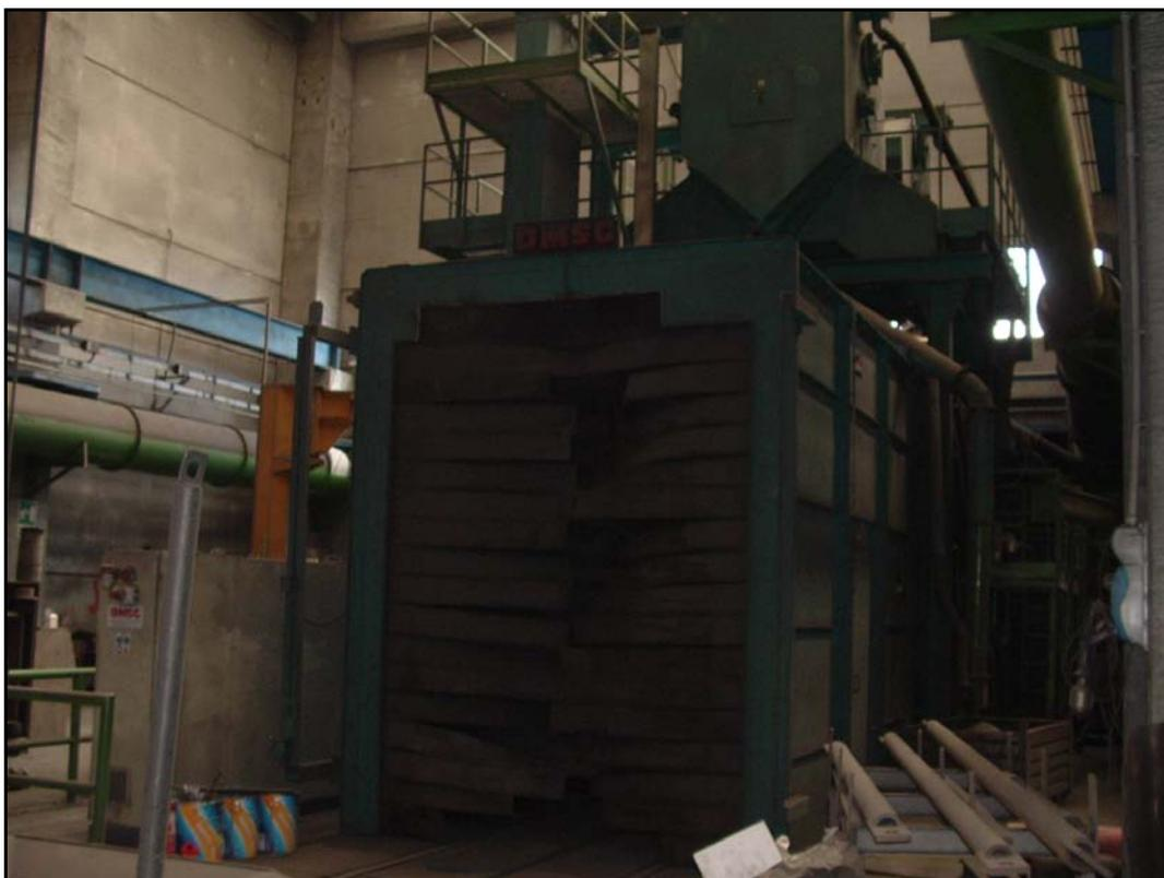
**FOTO N° 42: Sabbiatrice OMSG Modello TBLAST**
