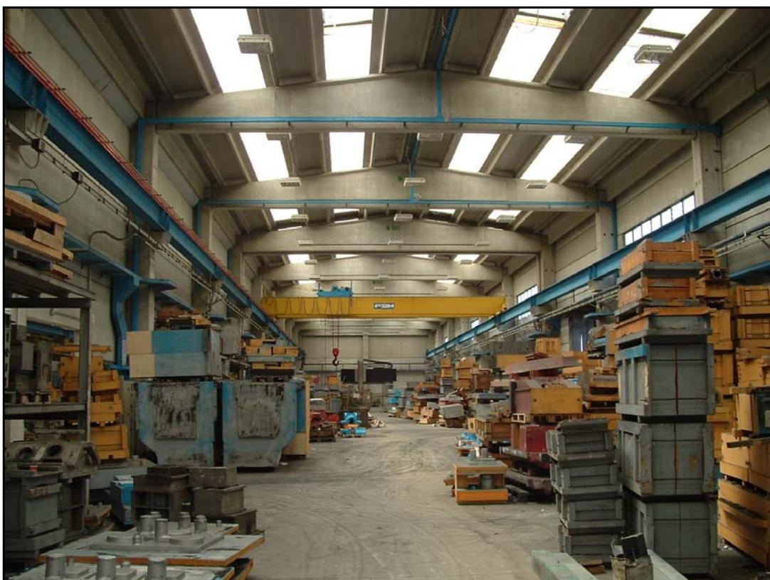
**FOTO N° 45: Campata E - si intravede in fondo Fresatrice e gru carroponete sigla 4855 da 25 T**
