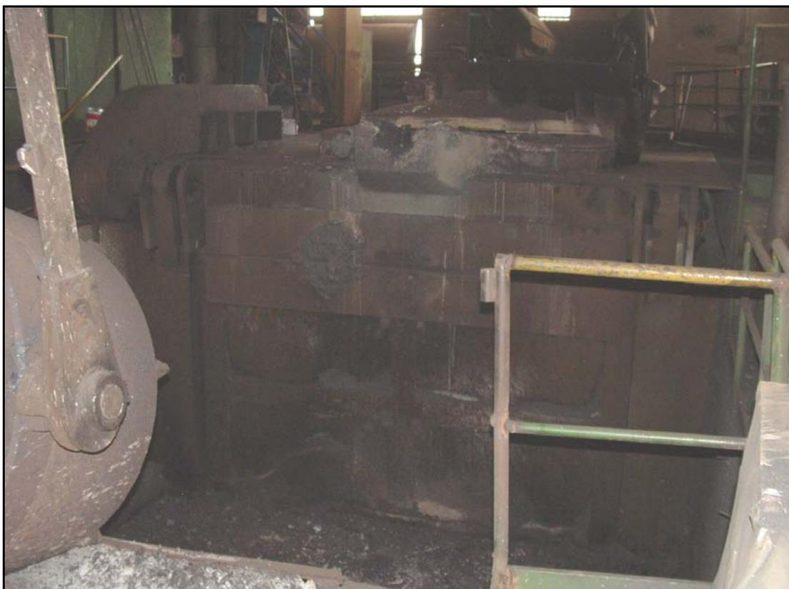
**FOTO N° 58:Forno Elettrico da 35 Tonnellate Marca Calamari**
