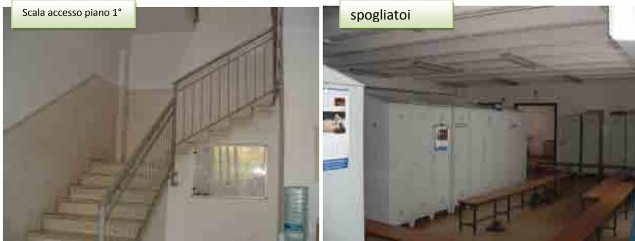
Mediante la scala laterale le maestranze accedono direttamente alla mensa o agli spogliatoi. I materiali di finitura sono di tipo economico (piastrelle in grès ceramico tipo 20x20), i tegoloni del solaio sono a vista così come gli impianti elettrici del tipo a canalina.
