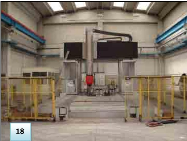
**18-Fresatrice ex Favretto di progettazione e realizzazione speciale avente finalità principale di fresatura di particolare grezzi di fonderia. Capacità di Lavoro 10x3 ml. Testa fresa birotativa da 6.000 giri/min. La gestione dell'impianto è CNC della Siemens modello Sinumerik 840 D. Consegnata in stabilimento nel Dicembre 2006.**
