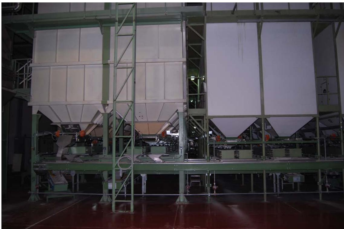
A monte dei due impianti è presente una fase di stoccaggio della semola assicurata da n. 10 silos, rispettivamente destinati allo stoccaggio delle semole, del triturato e del rimacinato, all'alimentazione delle presse delle linee di produzione pasta comprensivi di n. 4 linee di trasporto e di un sistema di gestione automatica del processo.
